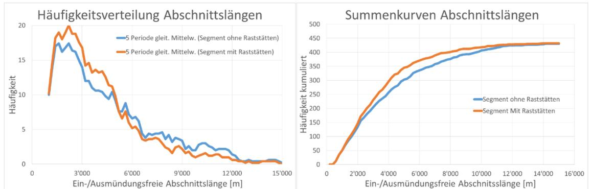
Abbildung 9 Häufigkeitsverteilung und Summenkurven der Abschnittslängen Schweizer Nationalstrassennetz
