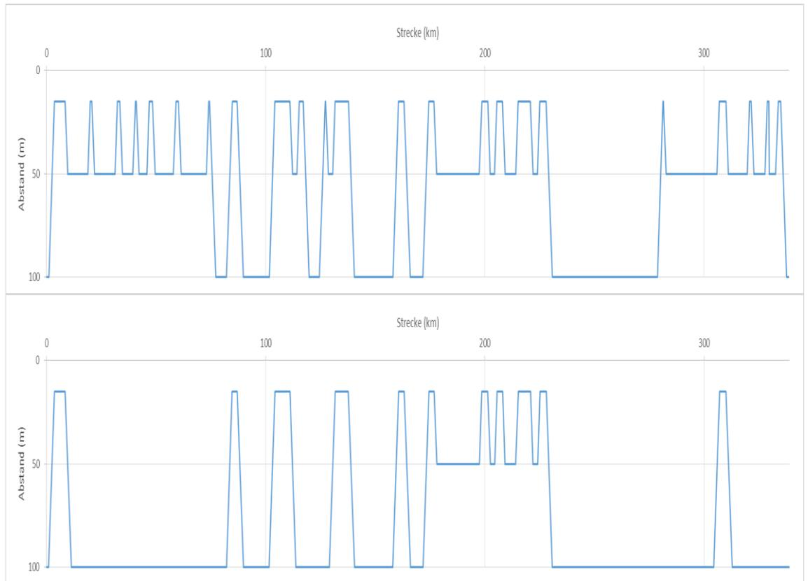
Abbildung 12 Verlauf Platoon mit Auflösung auf der Strecke A1; oben theoretisch, unten: praxisbezogen
