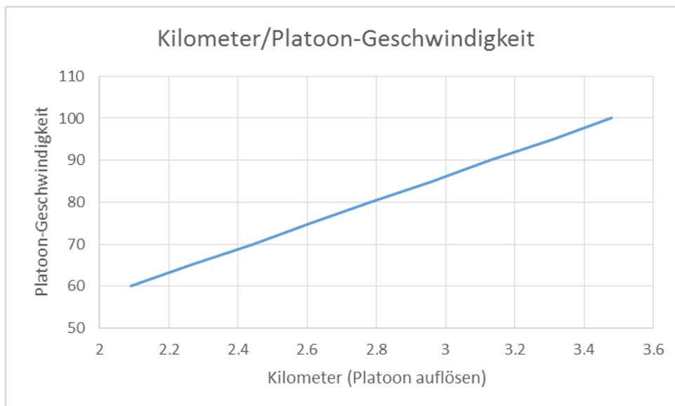
Abbildung 52 Ermittlung der optimalen Platoon-Geschwindigkeit
