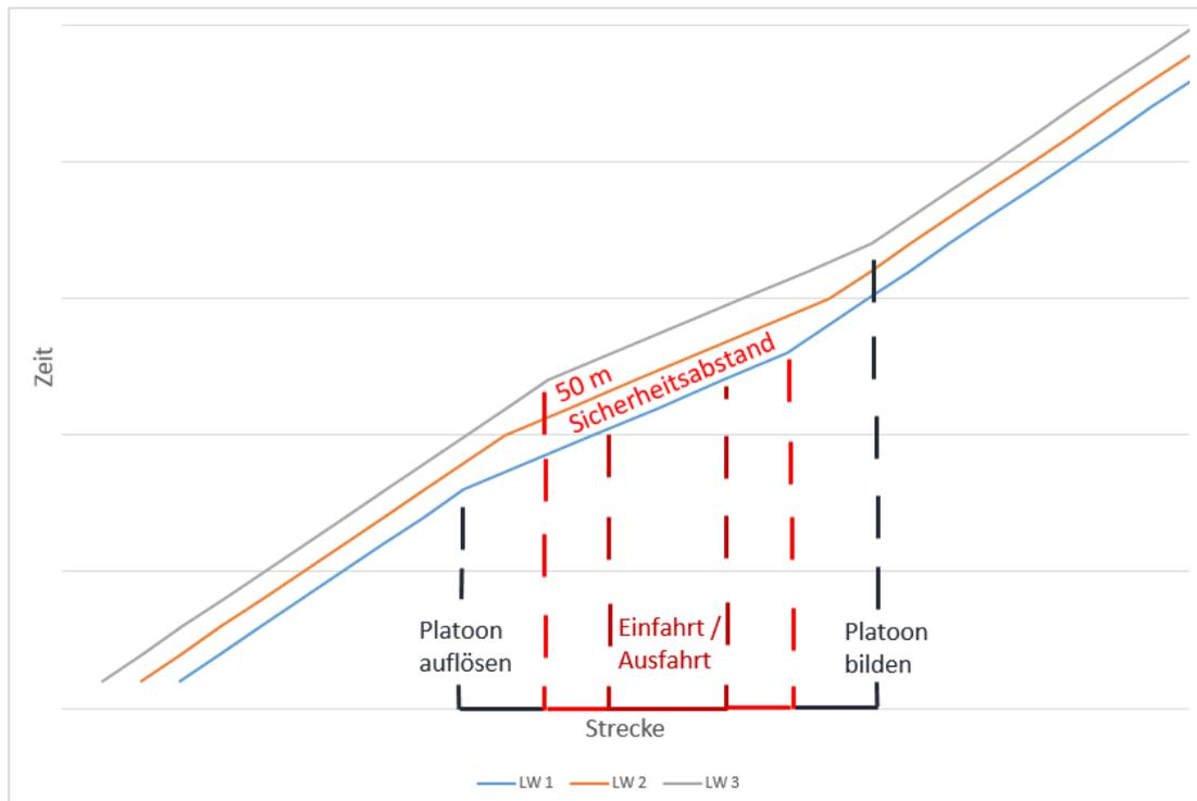
Abbildung 6 Platoon-Bildung und -auflösung bei Ein-/Ausfahrten (schematisch)
