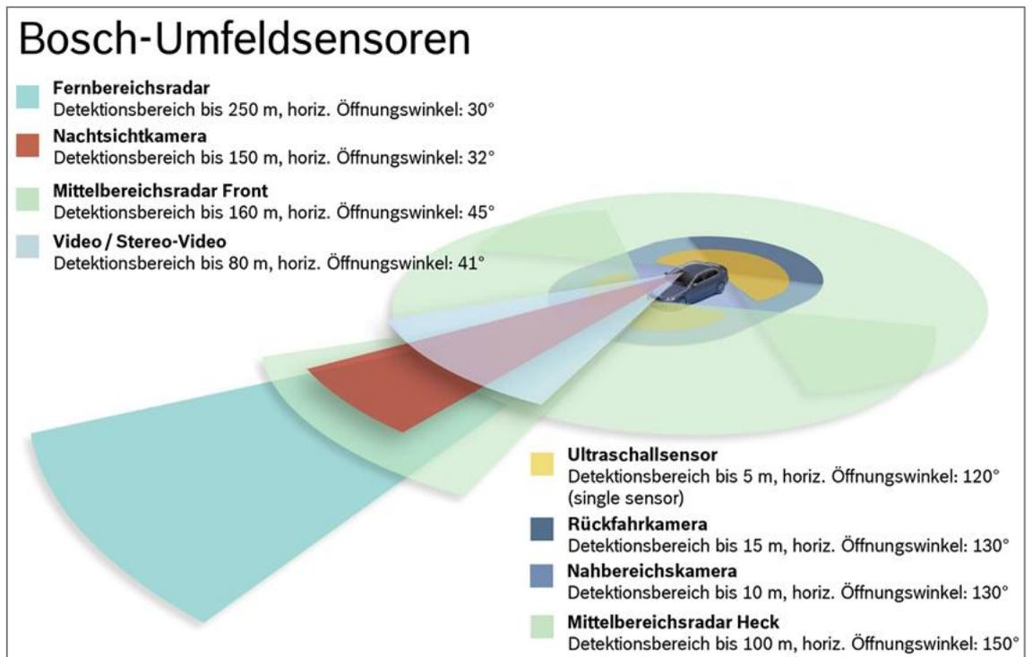
Abbildung 17 Umfeldsensoren für Fahrerassistenzsysteme<sup>19</sup>
